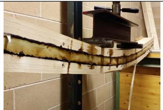
*Viga laminada con la última formulación de la bioresina. A pesar de que se alcanza el punto de rotura, no aparece delaminación.*
