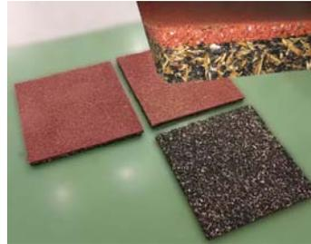
Presenta una capa inferior obtenida a partir de partículas de caucho procedente de neumáticos y madera reciclada, sobre la cual se aplica una capa menos gruesa de caucho sintético.
