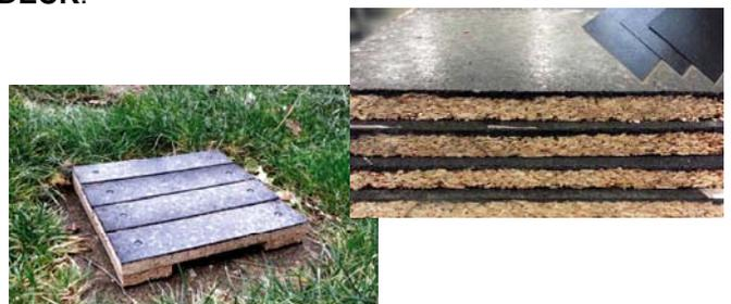
**BP2.- WOODRUB: Uso de madera y caucho reciclados para productos compuestos alternativos.**
